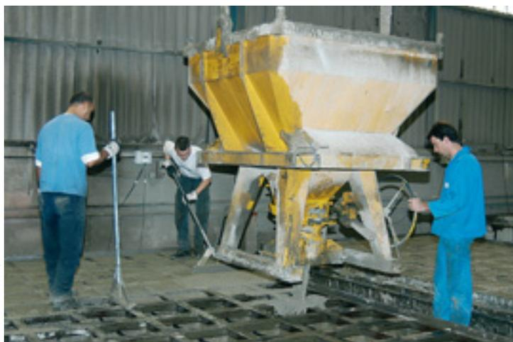
Chargeuse de béton
