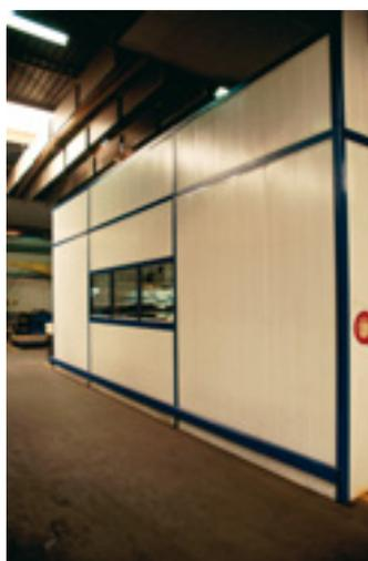
Zone de poinçonnage cloisonnée
