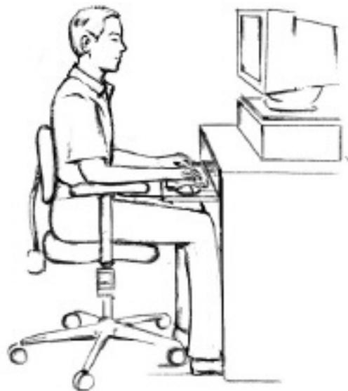
Luc a adapté son poste à sa taille : il a réglé son fauteuil pivotant dans une position plus basse et peut à présent poser ses pieds bien à plat sur le sol. Il a aussi réglé la tablette porte-écran pour amener l'écran à une hauteur appropriée et placé le clavier pour que ses bras soient dans une position confortable. Finalement, il a ajusté les accoudoirs de façon que ses avant-bras forment un angle de 90°.
