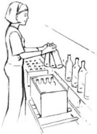
En examinant le poste d'Anne, on a constaté qu'il était possible de réduire l'espace entre les deux convoyeurs. Maintenant, Anne n'a plus besoin de s'étirer pour prendre les bouteilles sur le convoyeur du fond.
