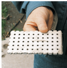
Tuiles de faux plafond
