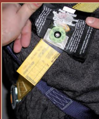
*L'utilisation d'un harnais de sécurité pour protection contre les chutes de hauteur est recommandée dans plusieurs situations de travail en hauteur. Son efficacité dépend de plusieurs éléments que l'on doit considérer attentivement, dont sa conformité à la norme CSA Z259.10 Harnais de sécurité. Il doit porter une étiquette indiquant cette conformité.*
