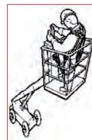
Un deuxième risque est l'éjection du travailleur de la nacelle suite au fouettement du bras articulé, particulièrement important avec les bras de grande portée. Pour le contrer, il faut alors utiliser un système d'arrêt de chute :
