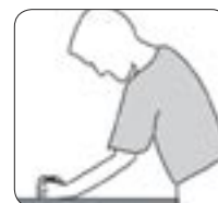
1. Une surface de travail trop basse entraîne souvent une posture contraignante pour le dos et le cou.
