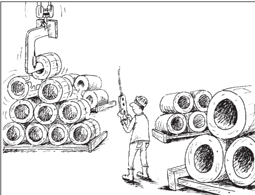
La hauteur d'empilage rend la pile de rouleaux instable.
