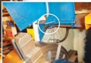
Un dispositif de protection commande l'arrêt de la machine dès l'ouverture du protecteur.
