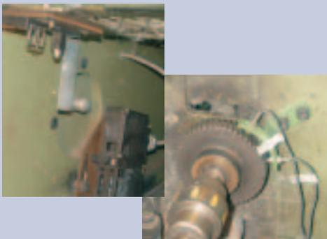
Dispositif à enclenchement lié à deux capteurs indiquant la présence de mouvement des engrenages
