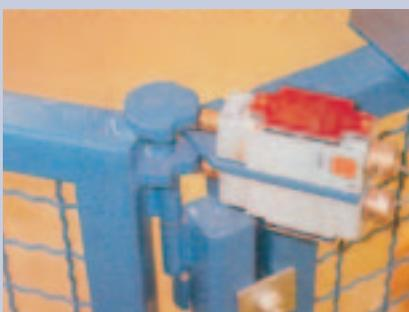
Dispositif d'interverrouillage sur une barrière donnant accès à une enceinte de protection
